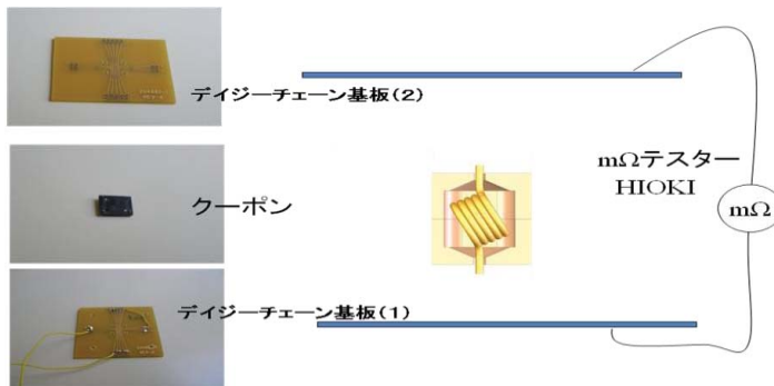
図 3. ディジーチェーンによる瞬断監視用クーポンと基板
